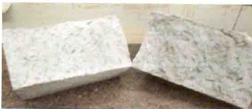
Foto n.º 01 Determinação da penetração de água sob pressão positiva.
