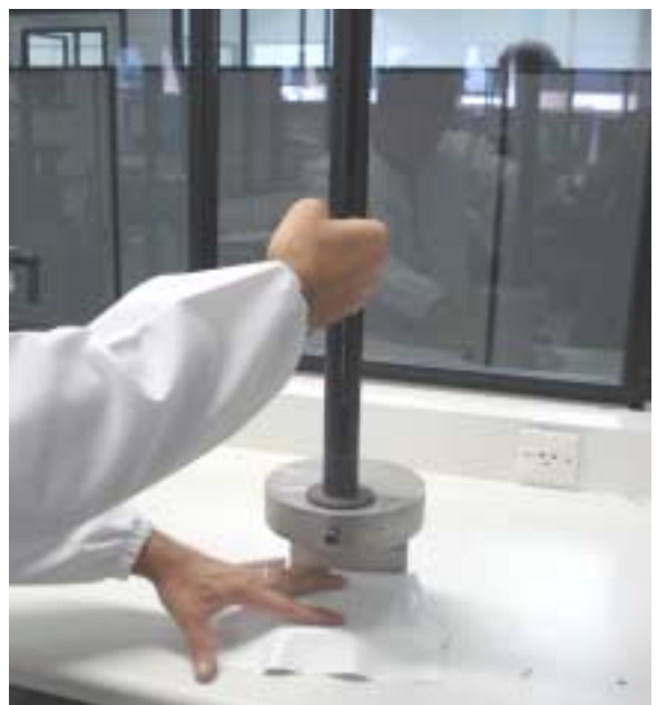
Foto 05: Resistência ao impacto 4,90 J (500mm de altura com massa de 1kg)
