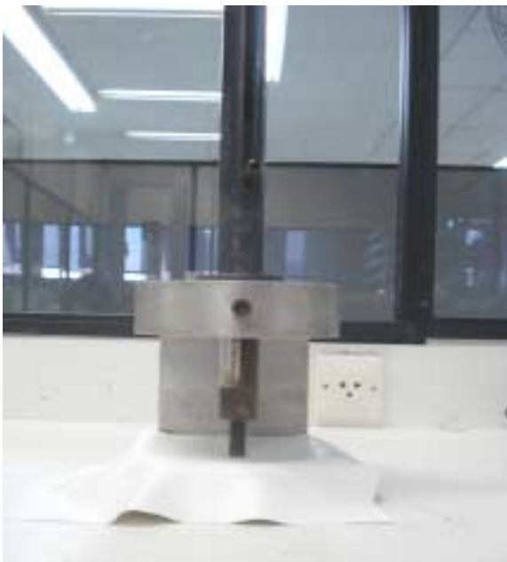
Foto 05: Resistência ao impacto 4,90 J (500mm de altura com massa de 1kg)
