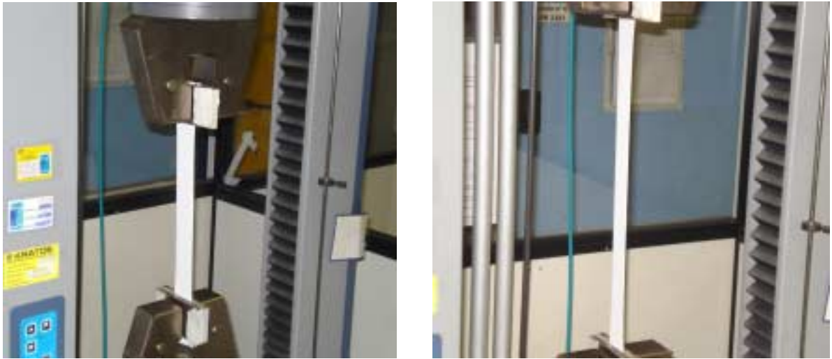
Foto 02: Resistência à tração e alongamento (corpo de prova de 300mm x 50mm)
